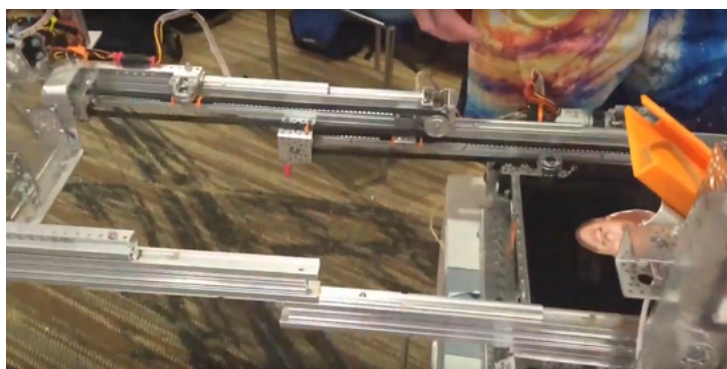
5064 Aperture Science Rover Ruckus, окончательная версия каскадного ременного привода
