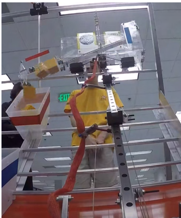
8221 Cubix, Res-Q, MGN слайды, соединенные деталями, напечатанными на 3D-принтере
