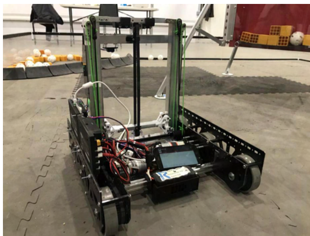
7236 Recharged Green, Rover Ruckus, изготовленный вручную линейный лифт с коробчатой трубкой
