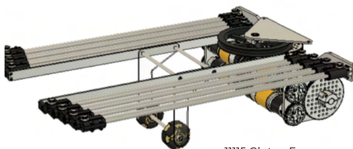
11115 Gluten Free, Skystone, круглые линейные подшипники и металлические валы с креплениями, напечатанными на 3D-принтере
