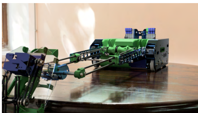
8417 'Lectric Legends, Rover Ruckus, круглые линейные подшипники и трубки из углеродного волокна с креплениями, напечатанными на 3D-принтере
