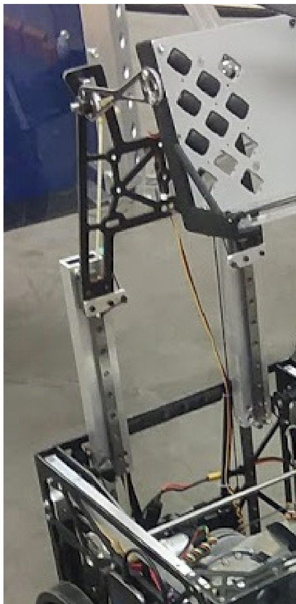
8813 The Winter Soldiers, Rover Ruckus, MGN12 слайды, соединенные кастомизированными трубами
