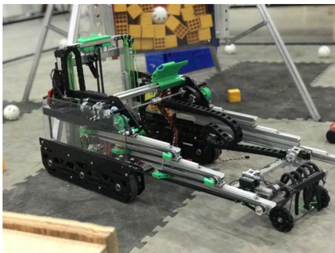
7236 Recharged Green, Rover Ruckus: держатель кабеля находится с левой стороны их горизонтальных слайдов и с правой стороны вертикальных слайдов
