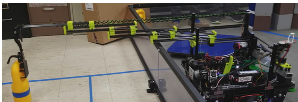
5975 Cybots, Relic Recovery, круглые линейные подшипники и трубки из углеродного волокна с креплениями, напечатанными на 3D-принтере
