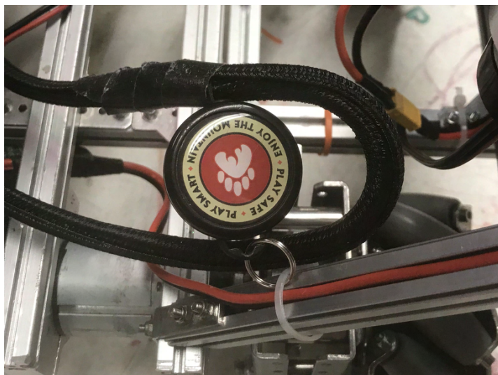
248 Fatal Error, Freight Frenzy: Ретрактор кабеля втягивающего устройства для бейджа на удлинительном механизме
